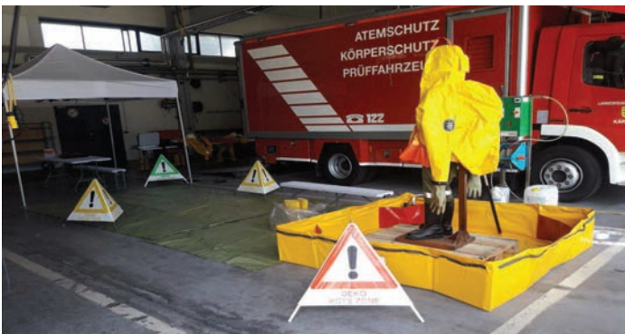
Dekoplatz mit Auffangbecken und Reinigungssystem. Zelt mit Beleuchtung und Heizung.
