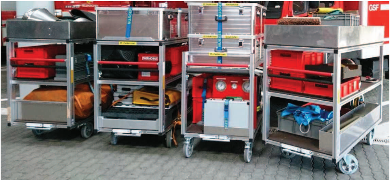
4 neue Container mit neuem System für den Gefahrenstoffeinsatz
