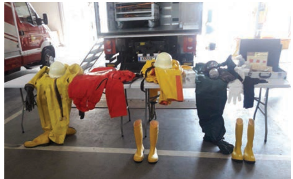
3 CSA mit Kälteschutzanzüge und Schutzstufe 2 Anzüge mit Stiefel, Masken, Unterwäsche, Helm, Filtermasken, Probenkoffer, Windmesser.
