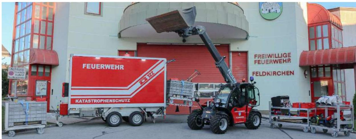
Der KAT-Anhänger mit Kofferaufbau und Ladebordwand wurde im Auftrag des Kärntner Landesfeuerwehrverbandes durch die Fa. Balthasar Nusser GmbH. aufgebaut. Die Ausrüstung des Anhängers setzt sich aus Elektrotauchpumpen, Wasser-/Restlossaugern, 3 kVA Generator und diverser Kleinmaterial zusammen.
