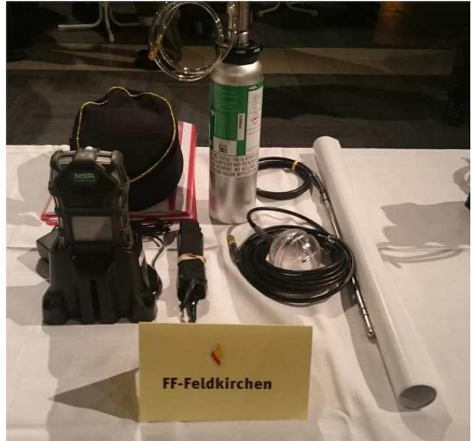
Das Gasmessgerät ALTAIR 5X kann gleichzeitig bis zu sechs Gase messen und ist mit integriertem PID-Sensor zur Erkennung flüchtiger organischer Verbindungen ausgestattet. Gestützt auf die fortschrittliche MSA XCell® Sensor Technology bietet das Gasmessgerät eine schnellere Ansprechzeit, höhere Stabilität und Genauigkeit, längere Nutzungsdauer. Gegenüber anderen Produkten kommt es auch zu Kosteneinsparungen während der gesamten Gerätelebensdauer.
